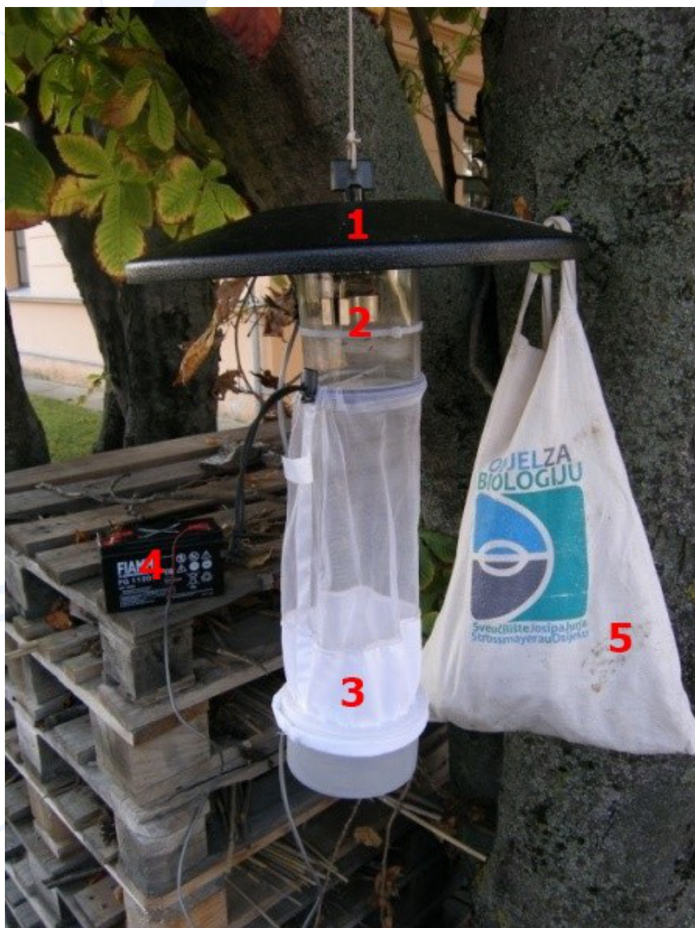
Slika 10. CDC klopka: Poklopac (1), cilindar s ventilatorom (2), mrežica (3), baterija (4), platnena vreća sa suhim ledom (5)
